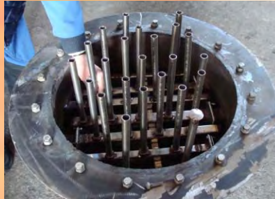
Montaža pećurki za fluidizaciju na distributor vazduha za fluidizaciju
