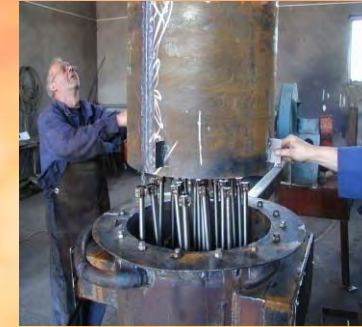
Montaža pećurki za fluidizaciju na distributor vazduha za fluidizaciju
