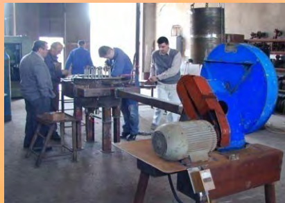
Montaža pećurki za fluidizaciju na distributor vazduha za fluidizaciju
